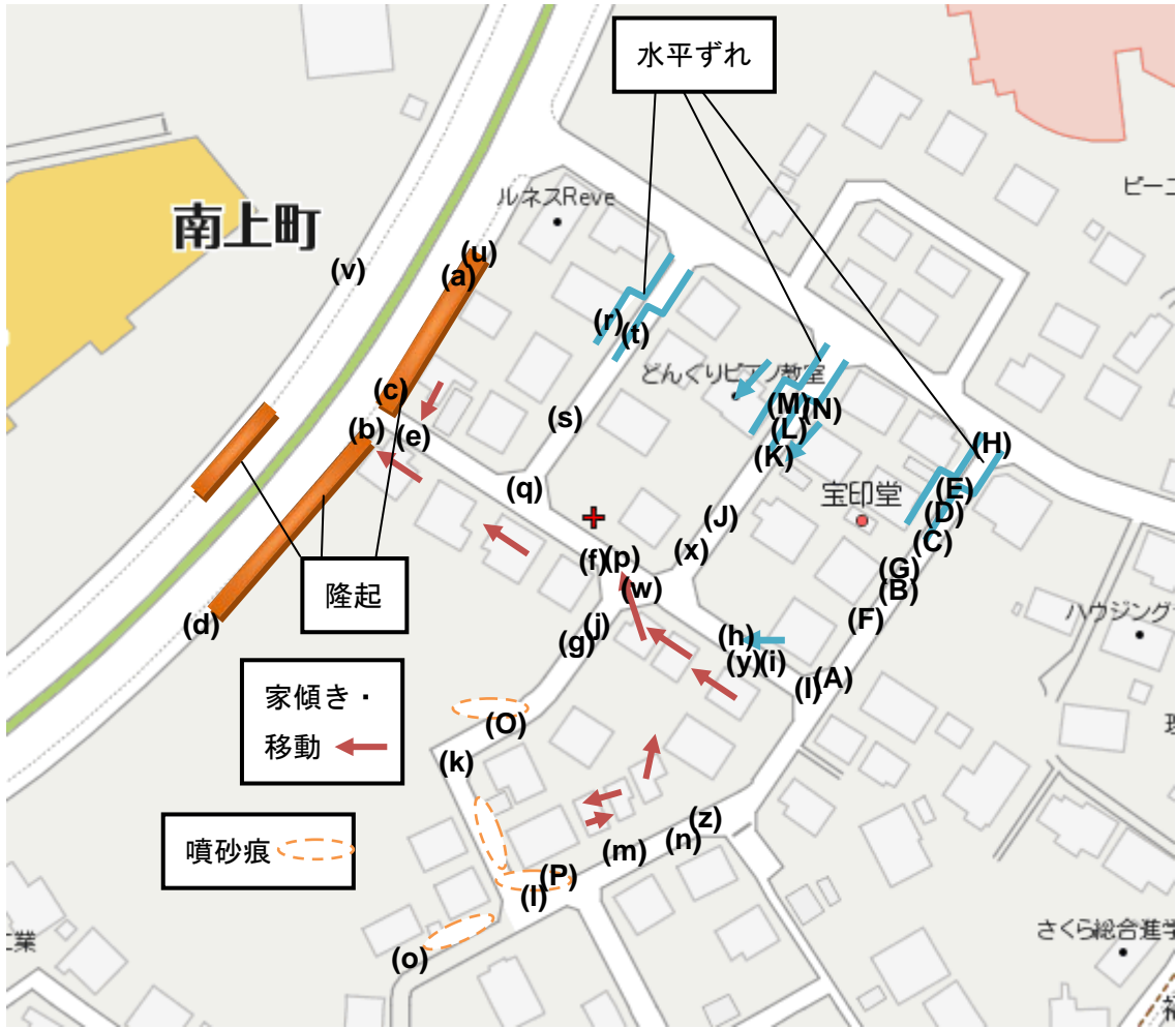
現地の被害状況と写真撮影位置
